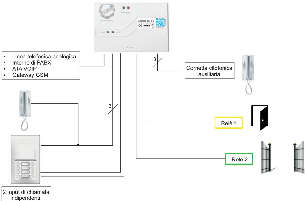
**Applicazione****Alimentazione****Assorbimento massimo (@12 Vdc)****Assorbimento minimo (@12 Vdc)****Corrente max contatti relè****Dimensioni****Peso***Tra una linea urbana analogica o una linea interna di PABX e un citofono**10 ÷ 16 Vdc**240 mA**30 mA**3A @ 120 Vac / 3A @ 24 Vdc**167 x 107 x 28 mm**275 g*
